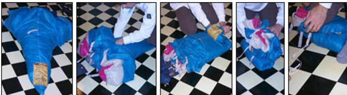
17. Placer le sac de déploiement bien ouvert et détortiller la drisse
